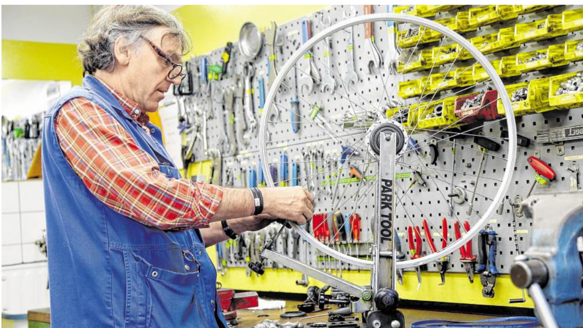
So wird das Rad wieder rund: Volker Neuwirth entfernt eine „Acht“ aus dem Rad. Die häufigsten Probleme haben sonst mit platten Reifen, kaputten Bremsen und defektem Licht zu tun.
